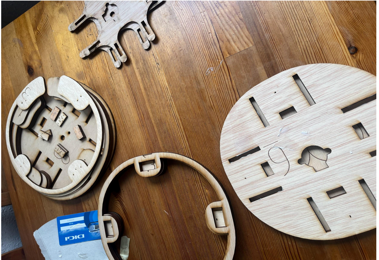
Imatge 51: peces provinents de la talladora laser. Font pròpia.
